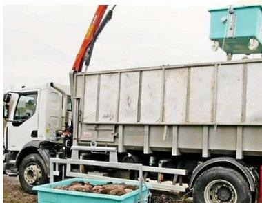
Illustration d'un camion relevant un bac d'équarrissage sur un point de collecte
